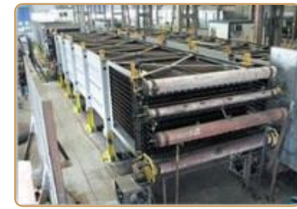
HRSG, Dow Chemical Plant, U.S.A., AUSTRIAN ENERGY
